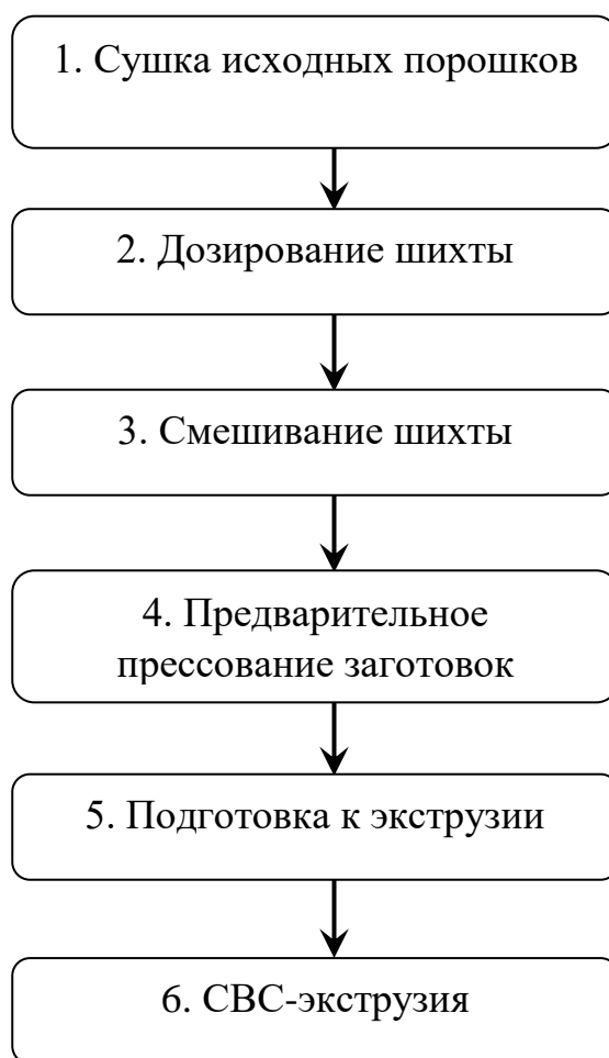
Рисунок 47 - Схема технологического процесса СВС-экструзии
