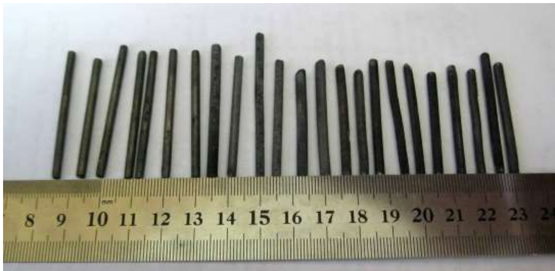
Рисунок 60 - Общий вид керамических СВС-электродов
