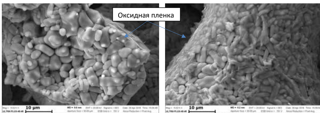
Рисунок 194 – Микроструктура частиц TiB_2 , полученных методом СВС
