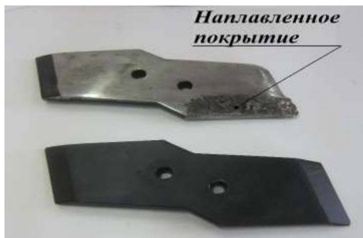
Рисунок 260 – Долото лемеха плуга Multi Master 112 фирмы KUHN, упрочненное СВС-электродом, после полевых испытаний, в сравнении с новым долотом
