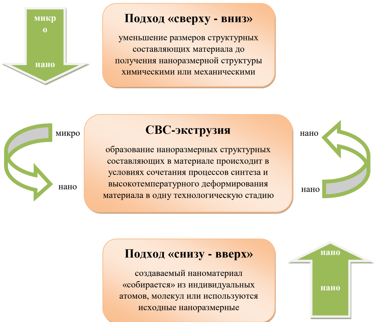
Рисунок 54 – Подходы для получения наноструктурных материалов
