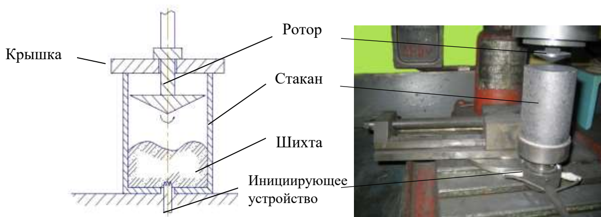
Рисунок 161 - Принципиальная схема реактора закрытого типа
