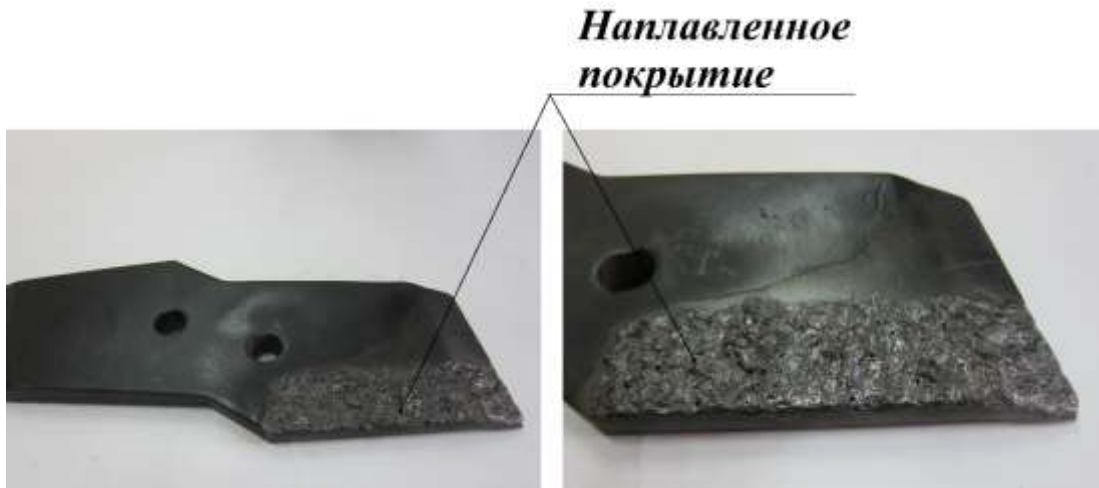
Рисунок 259 – Долото лемеха плуга Multi Master 112 фирмы KUHN, упрочненное СВС-электродом
